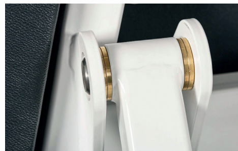
Латунные вставки в подвижных соединениях
